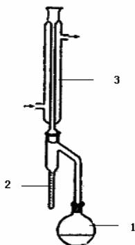
1. 250 mL 蒸馏瓶; 2. 水分接收管, 有刻度; 3. 冷凝管。
